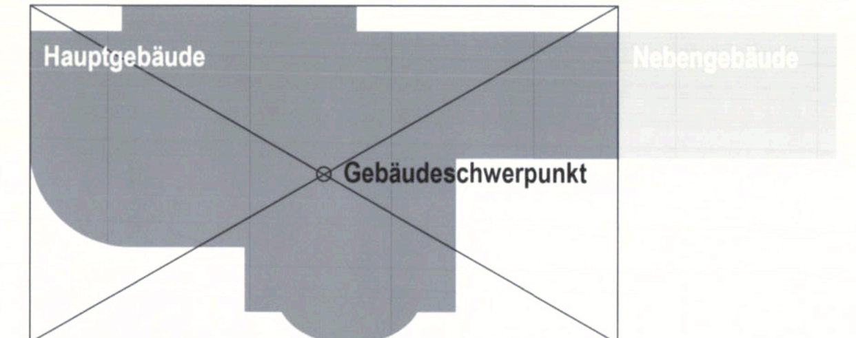
Systemskizze Ermittlung Gebäudeschwerpunkt
